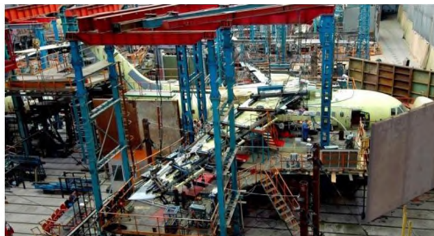
Рисунок 12 – Стенд для дослідження планера літака на міцність
