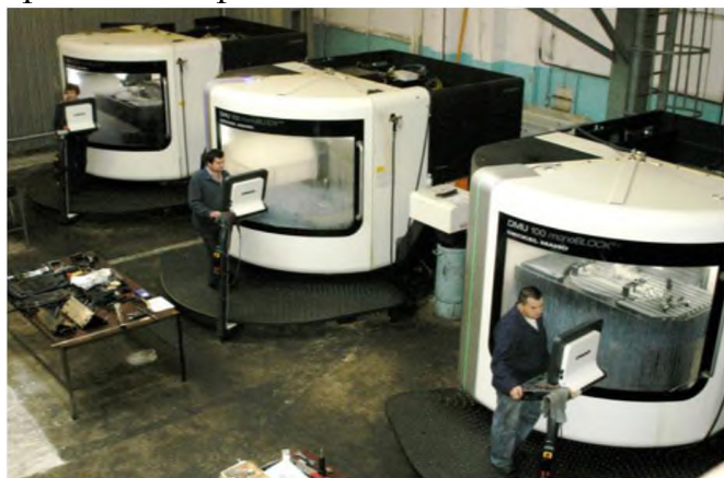
Рисунок 14 – Дільниця 5-координатних фрезерних верстатів
