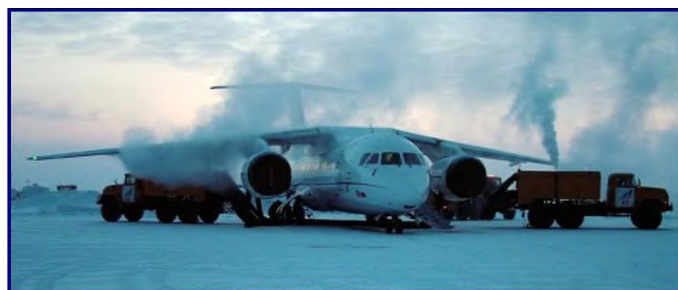
Рисунок 16 – Випробування при наднизьких температурах (до -55^{\circ}\text{C} ). Якутськ, Нерюнґрі (Росія)
