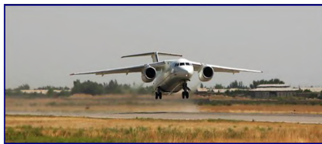
Рисунок 17 – Випробування при високих температурах (до +45^{\circ}\text{C} ) і в умовах високогір'я (висота аеродромів до 4100 м). Гюмрі (Вірменія), Карші (Узбекистан), Іран, Ла-Паз (Болівія)
