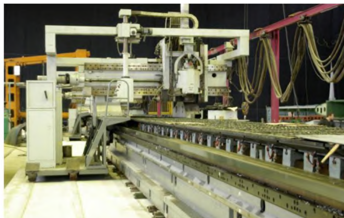
Рисунок 15 – Фрезерний верстат із ЧПК для виготовлення довгомірних деталей крила
